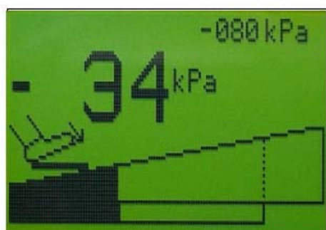
Рис.30. Пример: заданное значение вакуума: -80 кПа действительное значение вакуума: -34 кПа Индикация после перевода контроля уровня на ножной регулятор.
