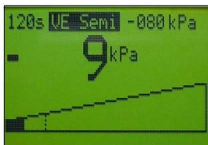
Рис.20. Меню VE Semi. Отсасывающее устройство пытается создать базовый вакуум -20 кПа.
